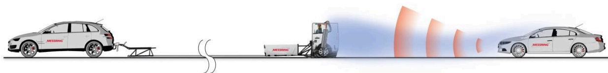
Exemplarische Illustration: Test mit Zugtarget (EVT oder SSV) mit Regensimulation bis zum Kollisionseintritt
