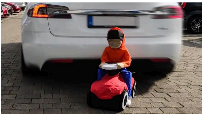
Testsituation mit Playing Child Target © MESSRING GmbH
